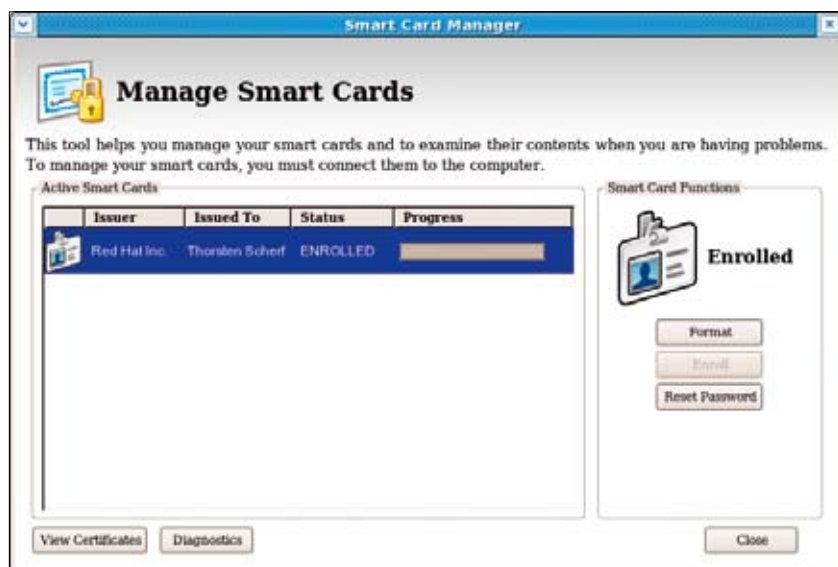
Abbildung 8: Über den Security-Client lässt sich die Chipkarte sehr einfach verwalten. Hier zeigt es die vorhandenen Zertifikate an.
