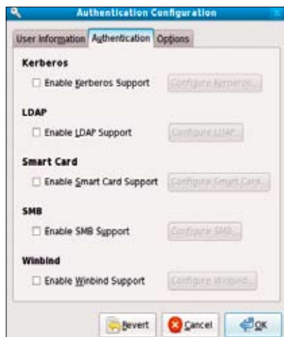
◀ Abbildung 5: Auf Fedora-Systemen steht mit »system-config-authentication« ein einfaches Tool zur PAM-Konfiguration zur Verfügung.
