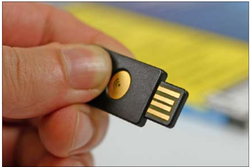
Abbildung 7: Der Yubikey für One-Time-Passwörter übergibt dank USB-Keyboard-Emulation ohne spezielle Treiber den Passwort-Hash an Anwendungen.
