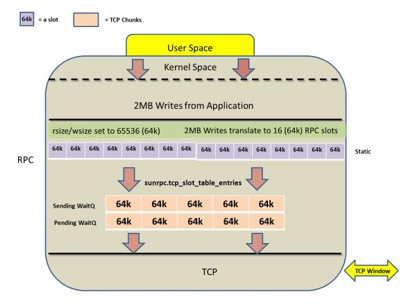
FIGURE 1) STATIC RPC SLOT LAYOUT WITH NFSV3/NFSV4.
